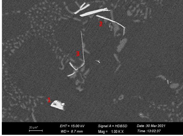
Şekil 3.52: Al+ağ%0,3 TiB 2 ile üretilen numunelerin SEM görüntüsü-690°C
