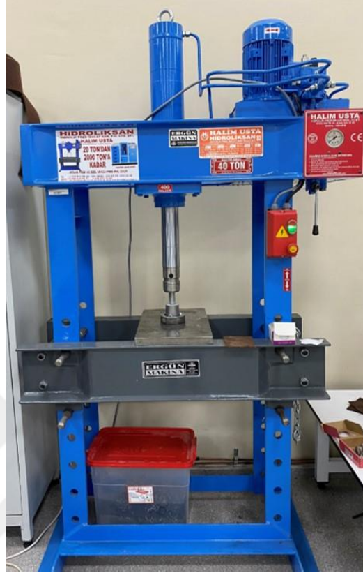
Şekil 2.9: Preslemede kullanılan hidrolik pres
