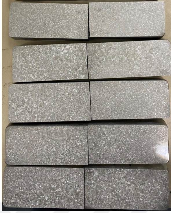
Şekil 2.18: Makroyapı incelemesi için hazırlanan numuneler
