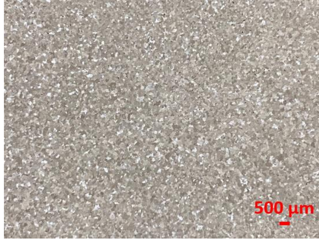
Şekil 3.18: Geleneksel çubuk formulu tane inceltici ile gerçekleştirilen üretime ait makroyapı görüntüsü
