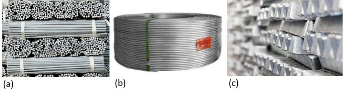
Şekil 1.3: Geleneksel tane inceltici Al 5 TiB alaşımları, a) Çubuk formu, b) Filmaşın formu, c) Külçe formu
