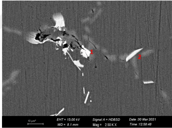
Şekil 3.55: AlTi5B ile gerçekleştirilen üretim SEM görüntüsü-720°C
