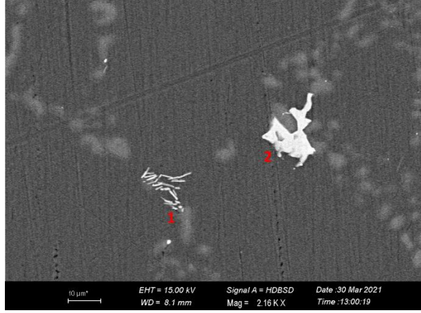
Şekil 3.54: Al+ağ%0,3 TiB 2 ile üretilen numunelerin SEM görüntüsü-720°
