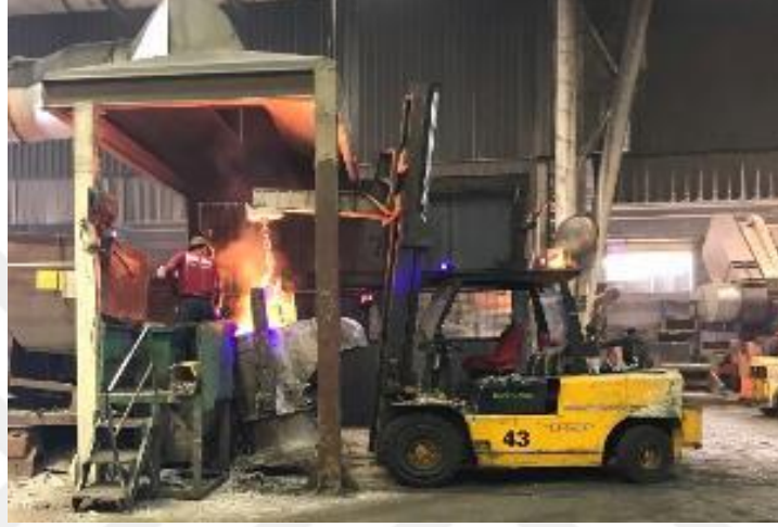
Şekil 3.7 : Cüruf temizleme istasyonu
