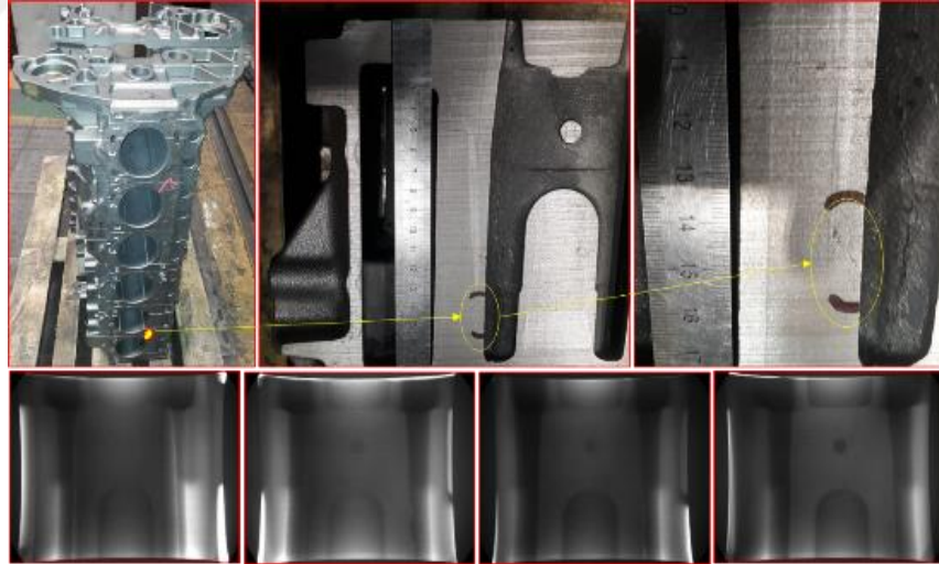
Şekil 4.15 : DDL – 210 madeni ile dökülen parçada 1 ve 2 numaralı silindirler arasında mikro çekintiler
