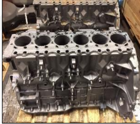
Şekil 3.10 : Temizleme işlemi sonrası
