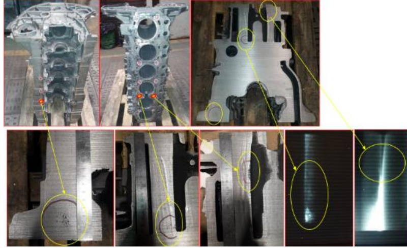
Şekil 4.9 : İşaretli bölgelerde kafa bağlama deliği delinince çıkacak ve kesin sızdıracak konumdaki CC4 ve CC5 seviyeli çekintiler
