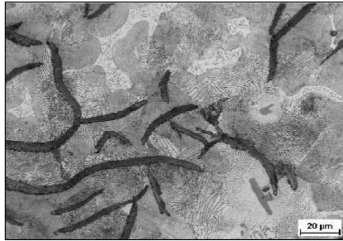
Şekil 2.3 : Perlitik matrisli gri dökme demirin optik mikroskopla çekilmiş mikroyapı fotoğrafı [13]
