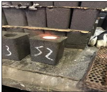
Şekil 3.12: Küresellik numunesi maçaları
