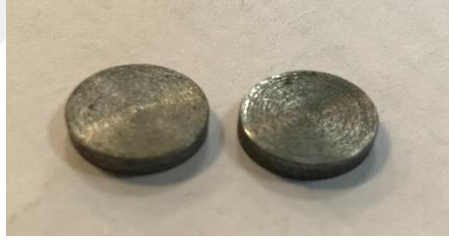
Şekil 3.28 : Termal iletkenlik numuneleri
