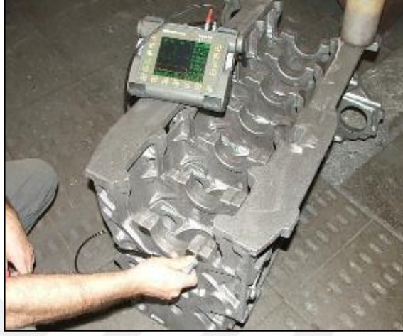
Şekil 3.17 : KrautKramer USM 35 UT cihazı ile ses hızı ölçümü
