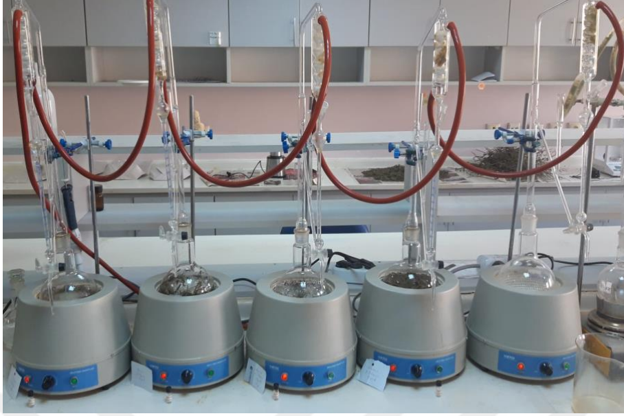
Şekil 3. 12. Uçucu yağ distilasyonu esnasında bir görünüm
