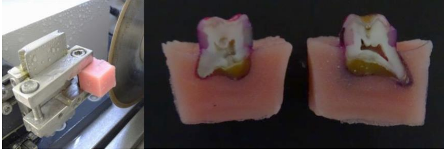
Şekil 2.14. Kesit alma cihazı Şekil 2.15. Kesit alınmış örnek
