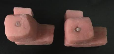
Şekil 2.20. Mikrogerilim bağlanma dayanımı testi için akrilik bloğa gömülen örnekler
