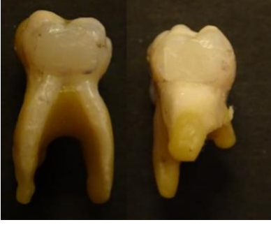
Şekil 2.11. Mum ile kök uçları kapatılan ve cila ile örtülen örnekler
