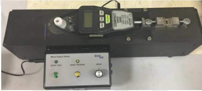
Şekil 2.24. Mikrogerilim bağlanma dayanımı test cihazı
