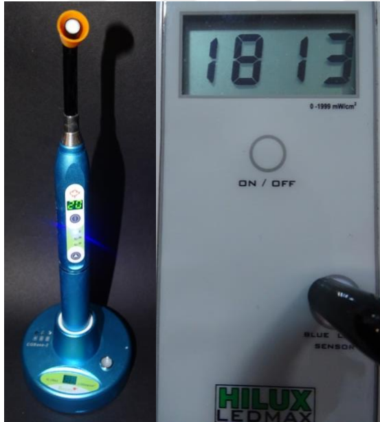
Şekil 2.5. Restoratif materyallerin polimerizasyonunda kullanılan LED ışık cihazı (GCP KarboLED CL-02)
