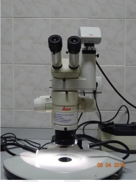
Şekil 2.16. Mikrosızıntı ve mikrogerilim bağlanma dayanım testinde kullanılan ışık mikrobi
