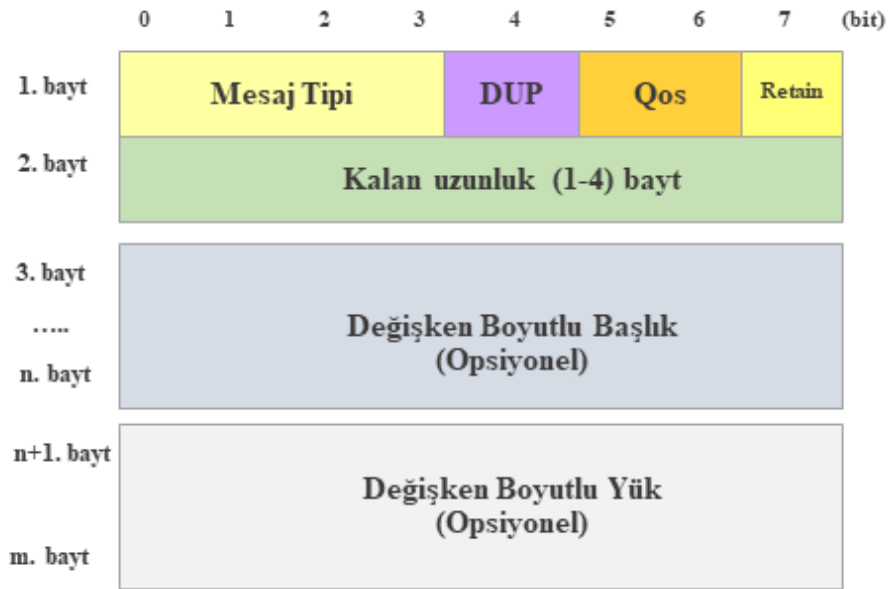
Şekil 3.9. MQTT çalışma prensibi
