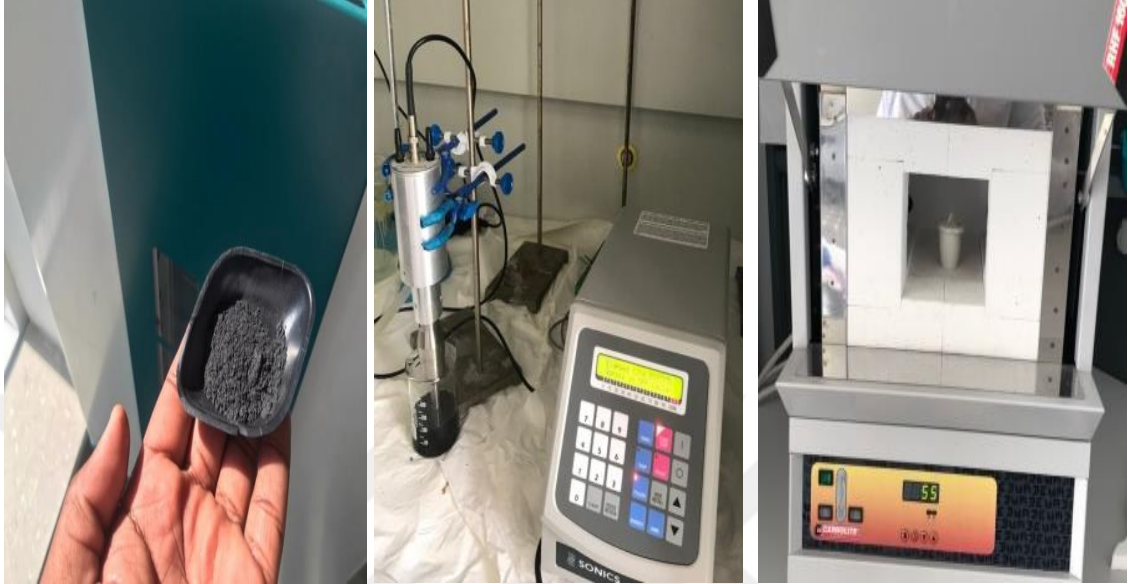
Şekil 3.1 Grafite uygulanan ön işlemlere ait görseller ( a- İşlemsiz b- Ultrasonikasyon işlemi c- 200°C'de 3 saat ön ısıtma işlemi)
