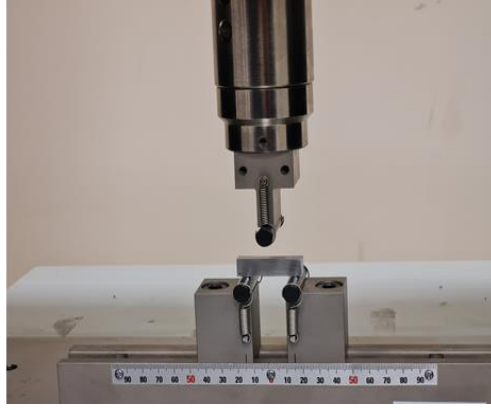
Şekil 7.13. Üç noktalı eğme testlerinin yapıldığı universal test cihazı
