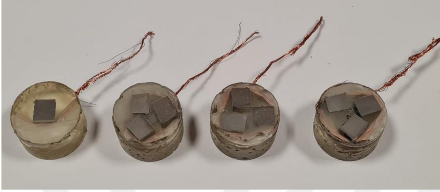
Şekil 7.15. Bakır kablo bağlanan epoksi reçineye alınmış numuneler
