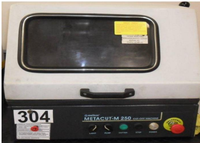
Şekil 7.9. Numune kesme cihazı
