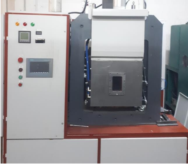
Şekil 7.6. Vakumlu sıcak pres makinesi.
