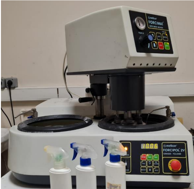
Şekil 7.7. Numune parlatma cihazı
