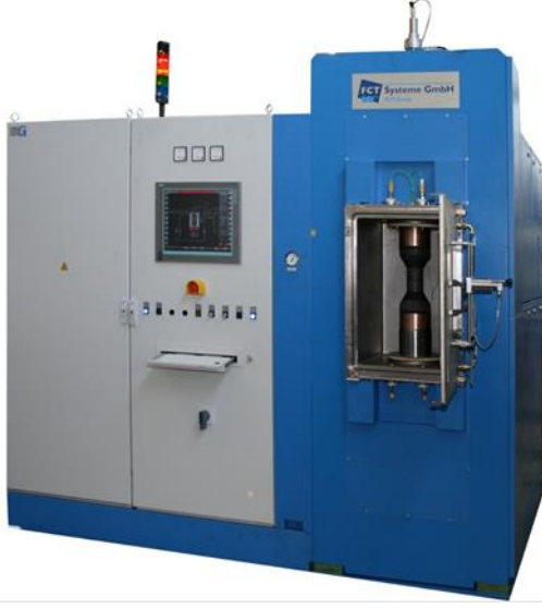
Şekil 6.4. Plazma sinterleme makinesi (FCT, Almanya)
