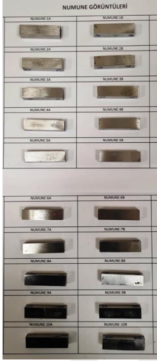
Şekil 7.8. Sinterleme sonrasında elde edilen numune yüzeylerinin temizlenmiş hali
