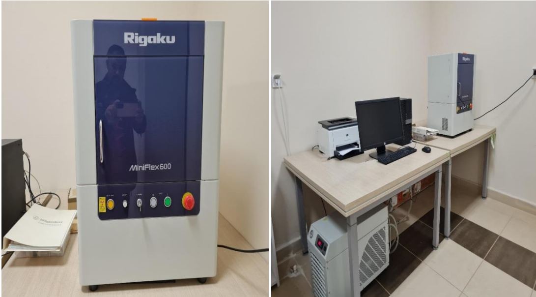
Şekil 7.16. Numunelerin X-ışını difraksiyon desenlerinin alındığı XRD cihazı
