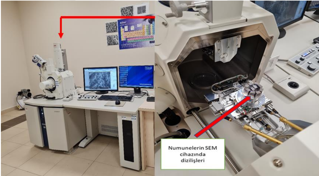
Şekil 7.14. SEM analizlerinin yapıldığı elektron mikroskobu.
