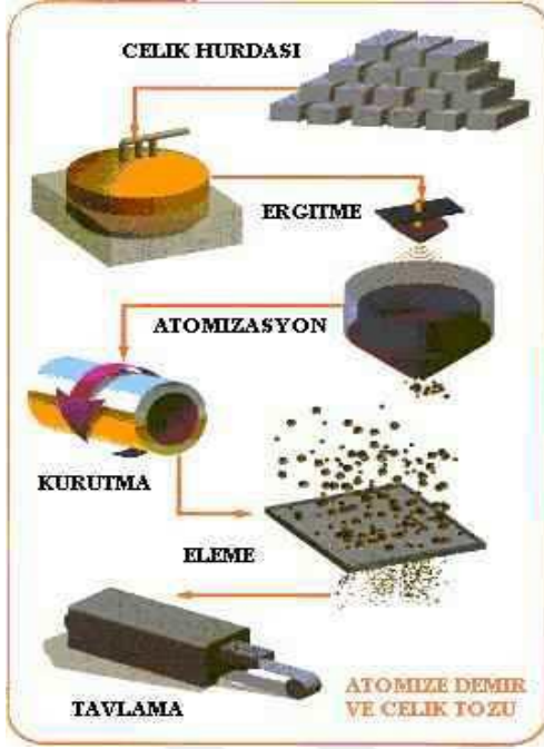
Şekil 2.6. Atomizasyon yöntemi ile demir ve çelik tozu üretim şematığı (Saritaş ve Doğan, 1994)
