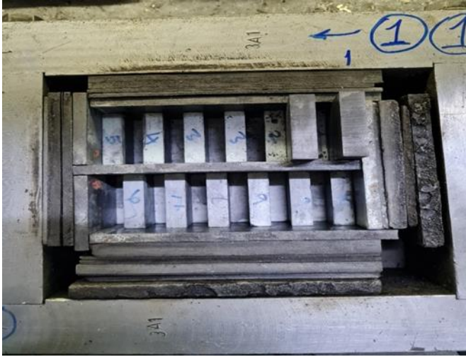
Şekil 7.5. Toz numune karışımlarının konulduğu bölmeli grafit kalıp.
