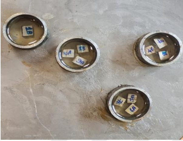
Şekil 7.10. Epoksi reçineye alınmış numuneler.
