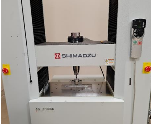
Şekil 7.13. Üç noktalı eğme testlerinin yapıldığı universal test cihazı
