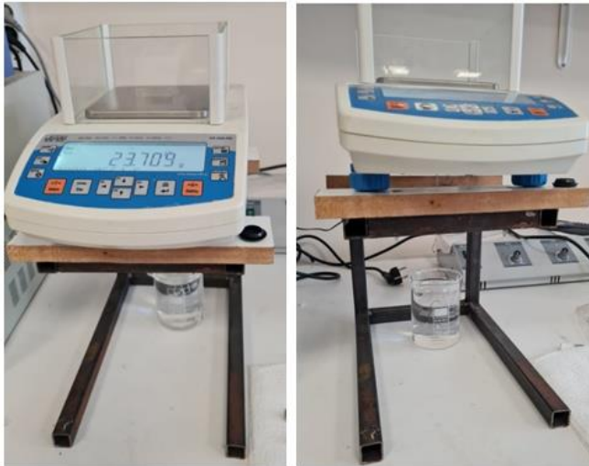
Şekil 7.12. Yoğunluk ölçümünde kullanılan test düzeneği
