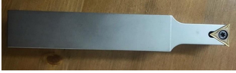
Şekil 2.3 Deneysel çalışmalar sırasında kullanılan kesici uçların takım tutucuya montajlanmış hali.
