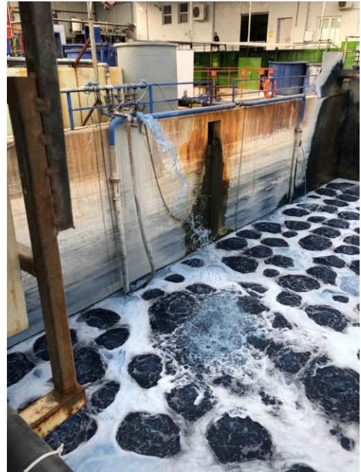
Şekil 5.2: Pomza taşı yıkaması sonrası oluşan atık su. (Fg Tekstil 2020, İzmir)
