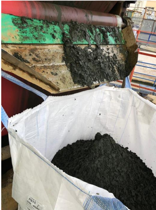
Şekil 5.1: Pomza taşı yıkaması sonrası oluşan çamur. (Fg Tekstil 2020, İzmir)
