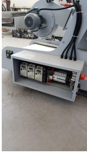
Şekil 17: Makine Elektriksel Sistemlerin Montajı
