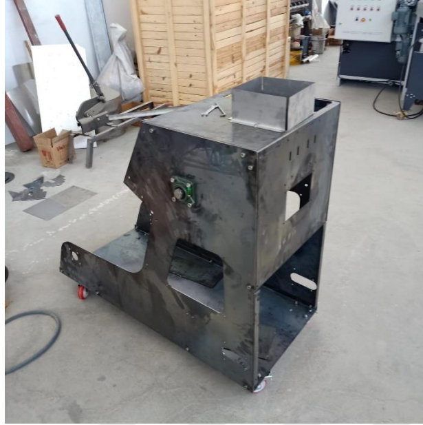
Şekil 16: Makine Dış Şase Montajının Yapılması
