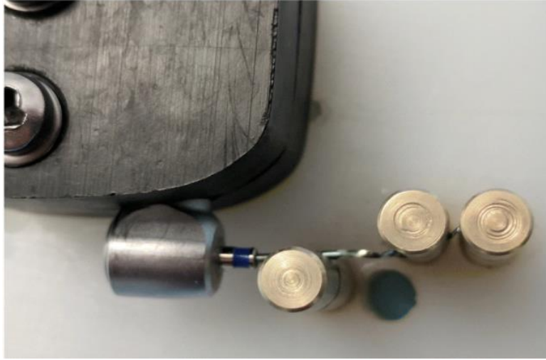
Şekil 2. 8: Dönen Bir Eğeyi Üç Noktada Eğimlendiren Düzenek (Ana Arias et al., 2019)
