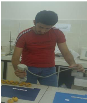
Şekil.3.8 Meyve kabuk ve etinde renk ölçümü
