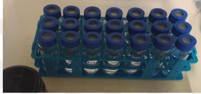
Şekil 3.4. Su buhar geçirgenlik analizi için hazırlanan deney düzeneği
