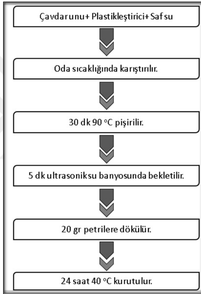
Şekil 3.1. Çavdar unu ve plastikleştirici yenilebilir filmin üretim aşamaları
