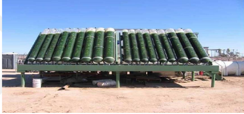
Şekil 2.20. Algepower Gmbh Manhattan, ABD’de yeni kurulan bir fotobiyoreaktör (Gezici, 2012).
