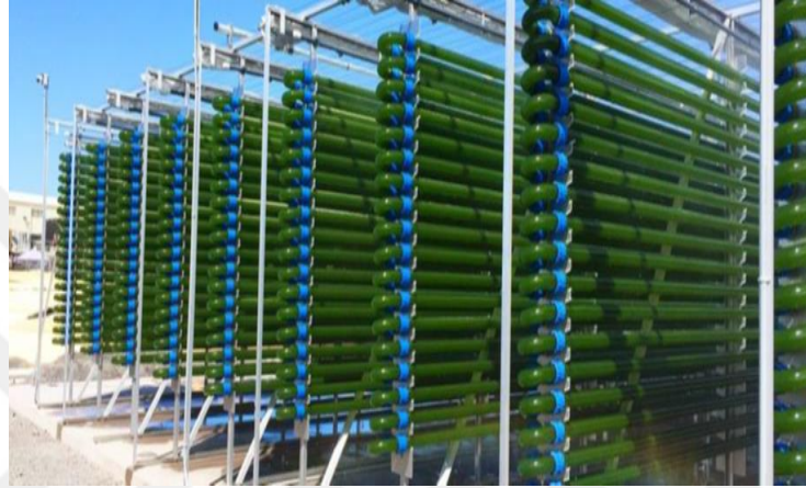
Şekil 2.14. Fotobiyoreaktörde horizontal üretim sistemi (Gezici, 2012).
