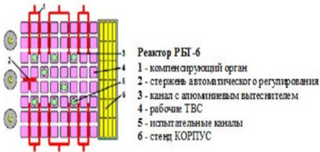
Рисунок 3.3 Поперечное сечение активной зоны реактора РБТ-6
