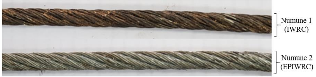
Őekil 3.10. Korozyon testinin ardından elik zlerin yzey grnmleri
