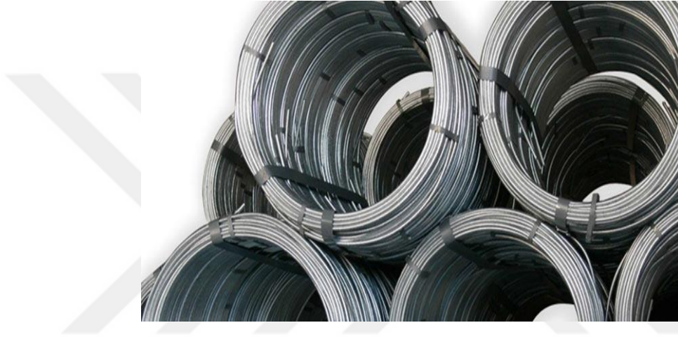
Şekil 2.10. Kangal haline getirilmiş filmaşın (Çelik, 2019)
