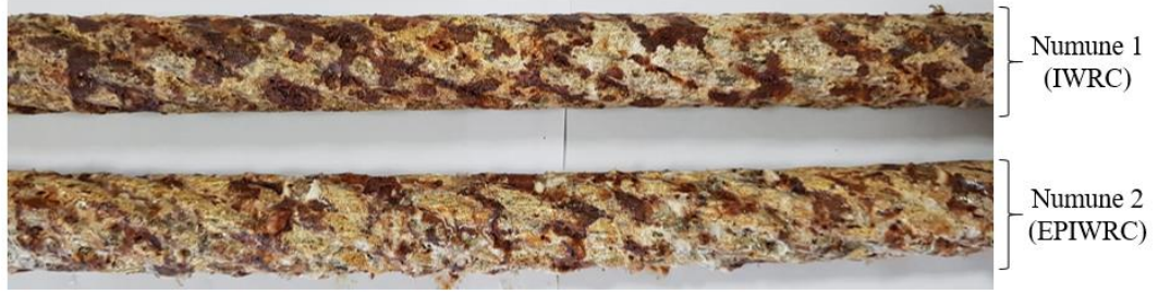
Őekil 3.9. Korozyon testinin ardından halatların dıŐ yzey grnmleri
