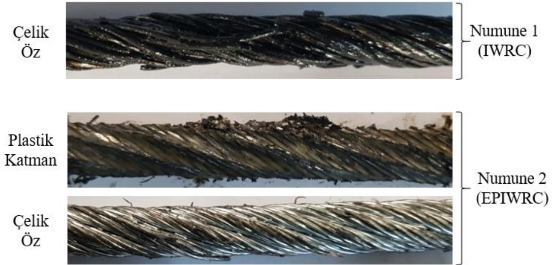
Şekil 3.4. Ömür testleri sonrasında çelik özlerin durumu
