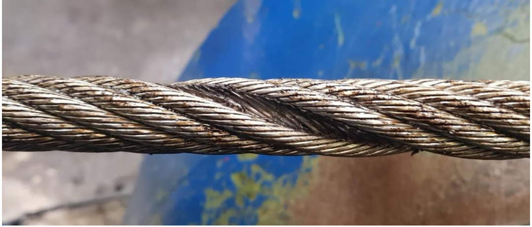
Şekil 3.5. EPIWRC halatın üretim görseli
