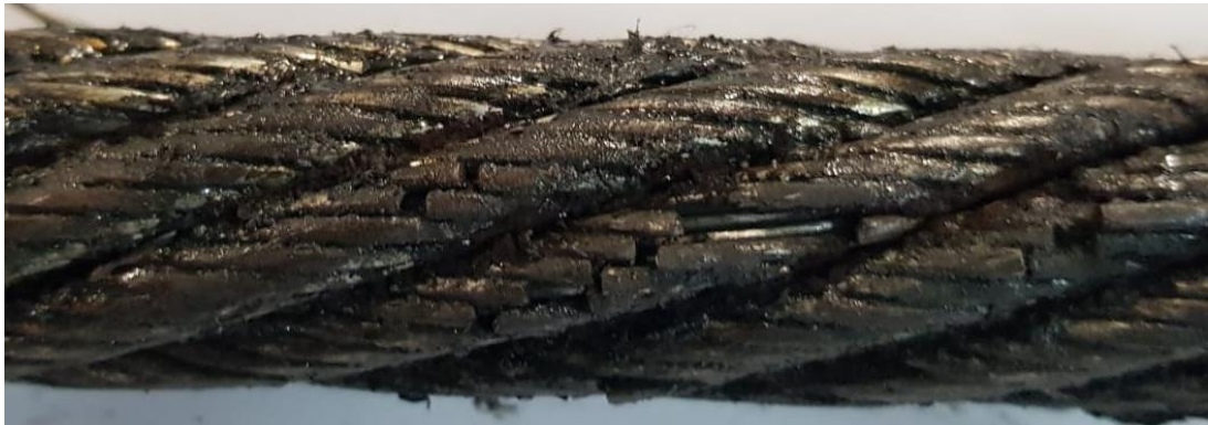
Őekil 4.3. mr testlerinde meydana gelen tipik yorulma kırılmaları
