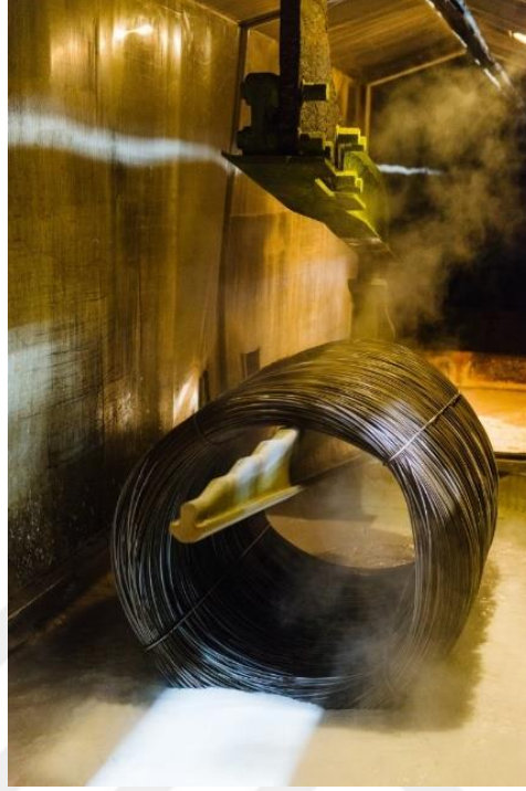
Şekil 2.11. Filmaşının kimyasal yüzey temizleme işlemi (Surface Treatment of Wire, t.y.)
