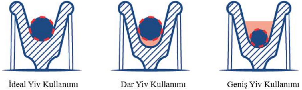
Şekil 2.21. Çelik halatların makara yivi ile temas karakteristiği (Çelik Halat ve Tel Sanayi A.Ş. Ürün Kataloğu, 2020)
