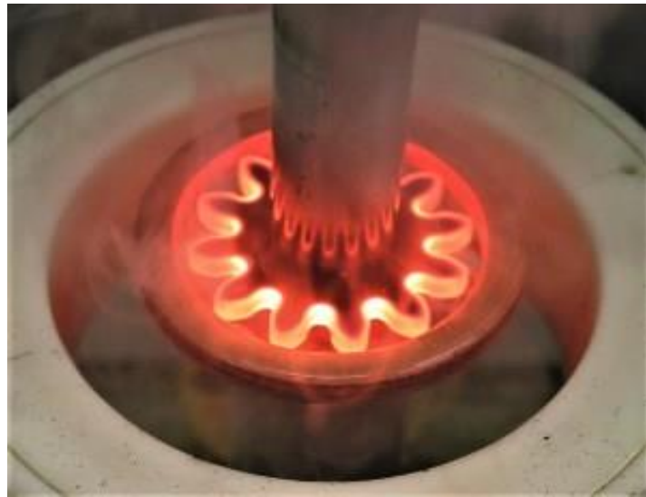
Şekil 2.9: Dişliye uygulanan indüksiyon sertleştirilmesi.
