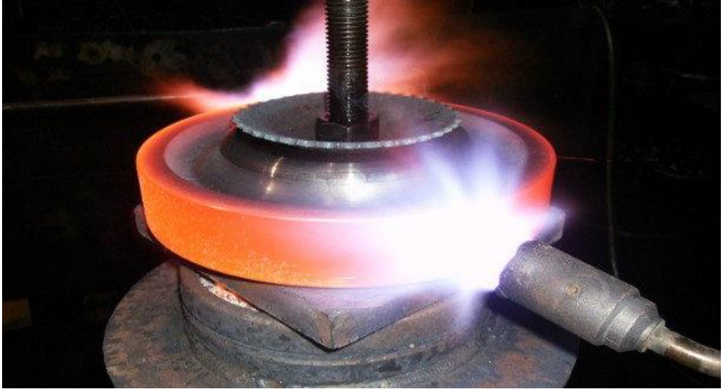
Şekil 2.4: Bilezik şekilde olan malzemenin alevle sertleştirilmesi.
