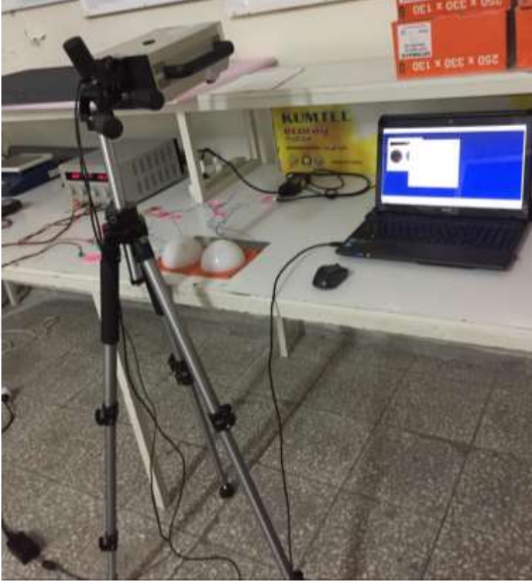
Şekil 3.35. Termal kamera ile meme fantomunun çekim düzeneği.
