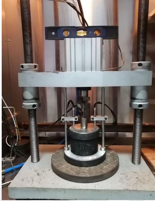
Şekil 4.22. Dinamik sünme deney düzeneği
