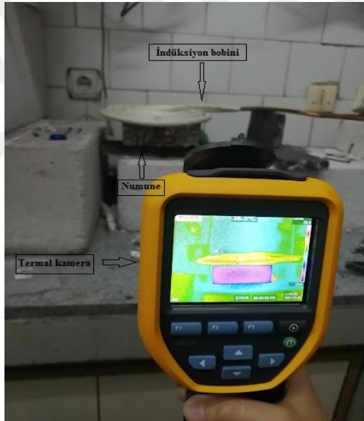
Şekil 4.26. İndüksiyon ısıtması düzeneği
