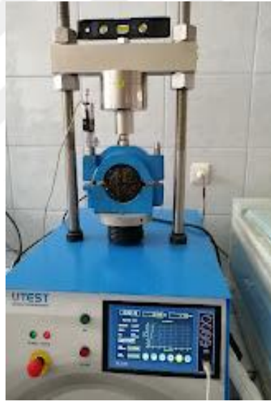
Şekil 4.15. Marshall stabilite ve akma deneyinin yapılışı
