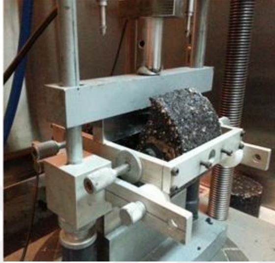
Şekil 4.19. Yorulma deney düzeneği
