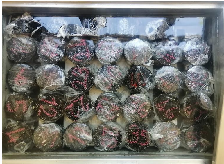
Şekil 4.16. Numunelerin streç film ile sarılıp bekletilmesi
