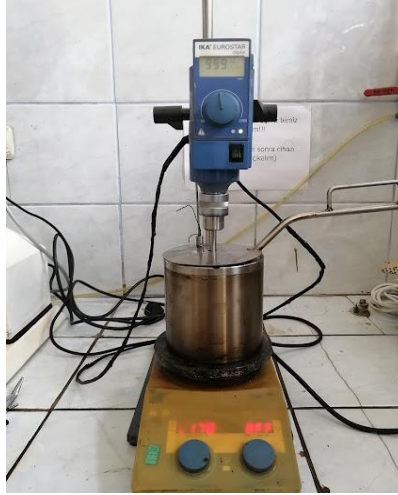
Şekil 4.6. Mekanik karıştırıcı ile modifiyeli bağlayıcı hazırlama işlemi
