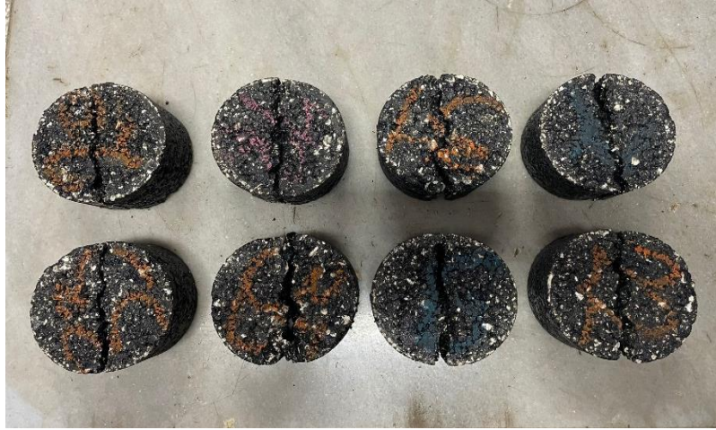
Şekil 5.20. ITFT deneyi sonunda numunelerin görünüşü
