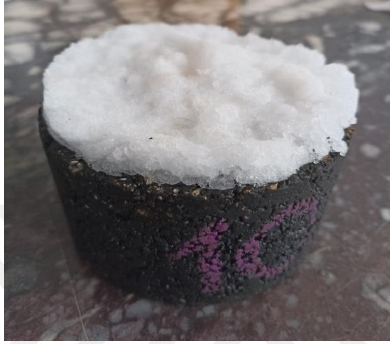
Şekil 4.28. Kar eritme deneyi için örnek
