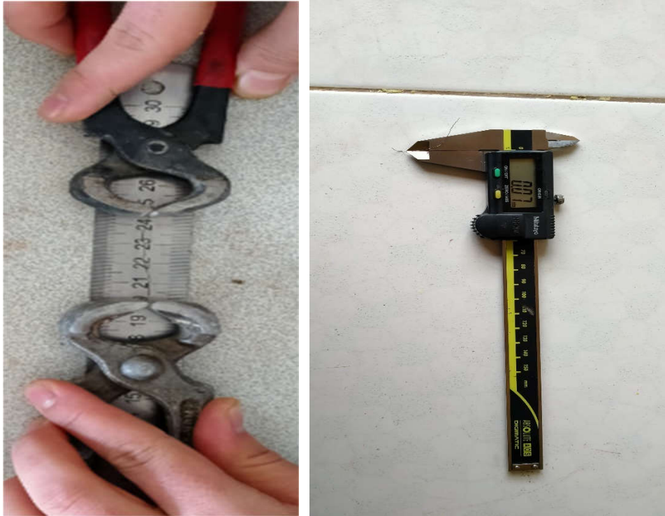
Şekil 26. Atık lastikten elde edilen çelik lifin boy ve çap ölçümü
