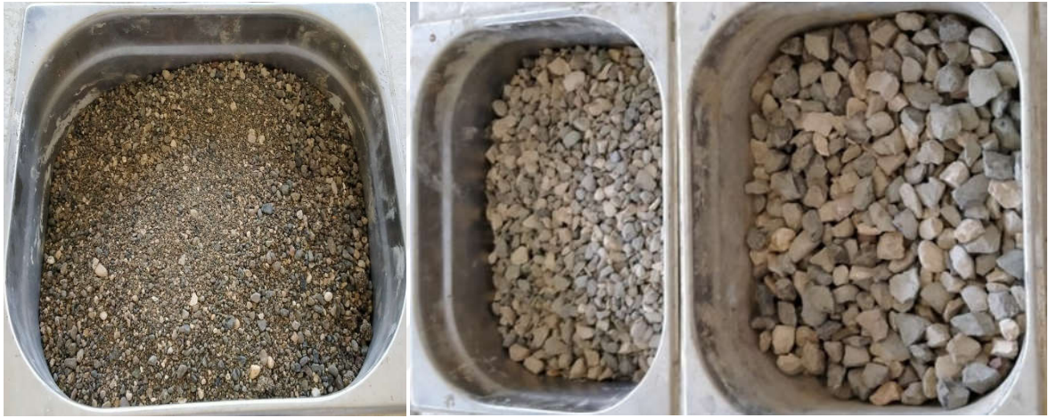
Şekil 19. İnce ve iri agregaların görüntüsü (soldan sağa: 0/4, 4/8 ve 8/16 tane sınıfı)
