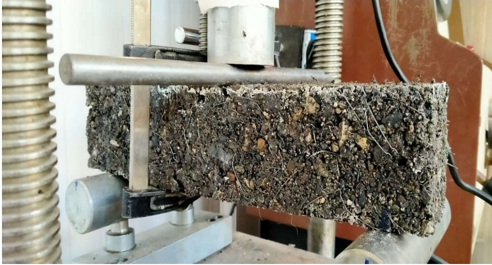
Şekil 69. İçi tam olarak sertleşmeyen AL7,5AÇL0,33 kodlu numunenin ezilerek kırılması
