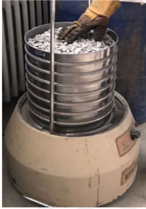
Şekil 20. Deneyde kullanılan elekler ve titreşimli elek analizi test cihazı
