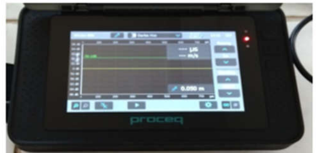
Şekil 30. Ultrasonik Dalga Hızı Test Cihazının tedarikçi firmanın sayfasından alınan resmi ve okumaların yapıldığı ekranın görüntüsü (solda)
