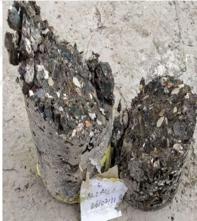
Şekil 37. AL=0 olan numunelerin basınç deneyi altındaki kırılma biçimine örnek (AL0AÇL1)
