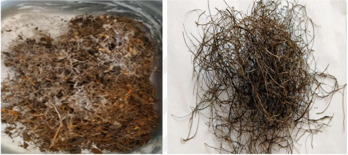
Şekil 25. Atık lastikten çıkarılan çelik tellerin ayrıştırmadan önce (soldaki) ve sonraki hali
