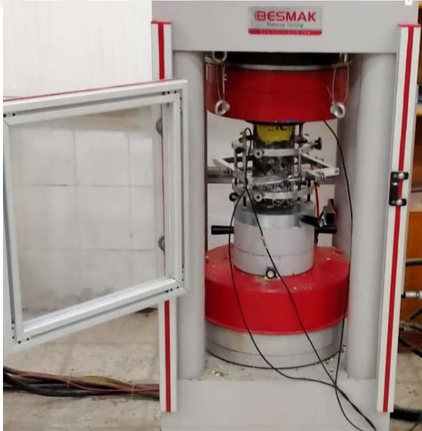
Şekil 32. Gerilme şekil değiştirme deney aleti ve deney aşamasından görünüm
