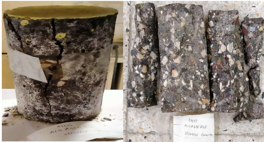
Şekil 36. KAL0AÇL0EÇL0 kodlu numunenin basınç deneyi sonucunda gevrek kırılma şekli
