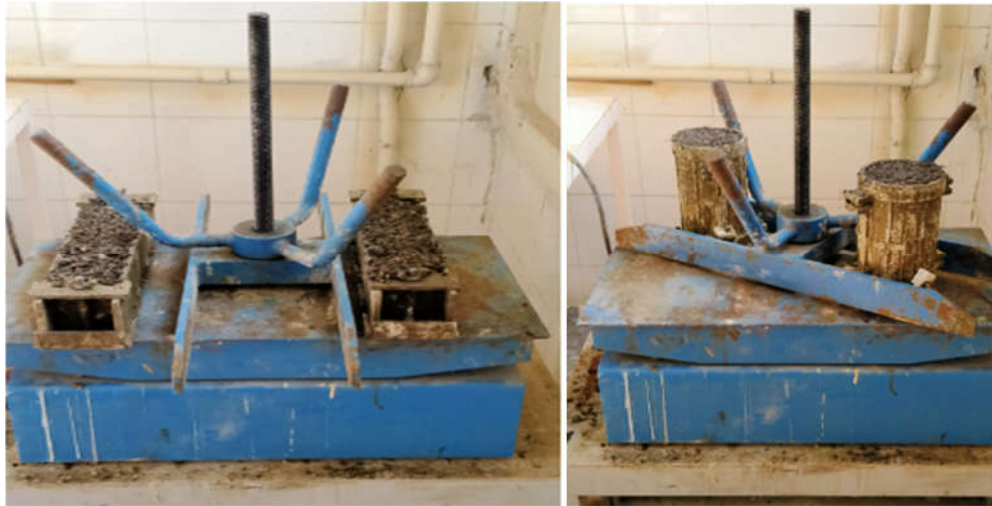
Şekil 27. Deneyde kullanılan masa tipi vibratör ve içi dolu numune kalıpları
