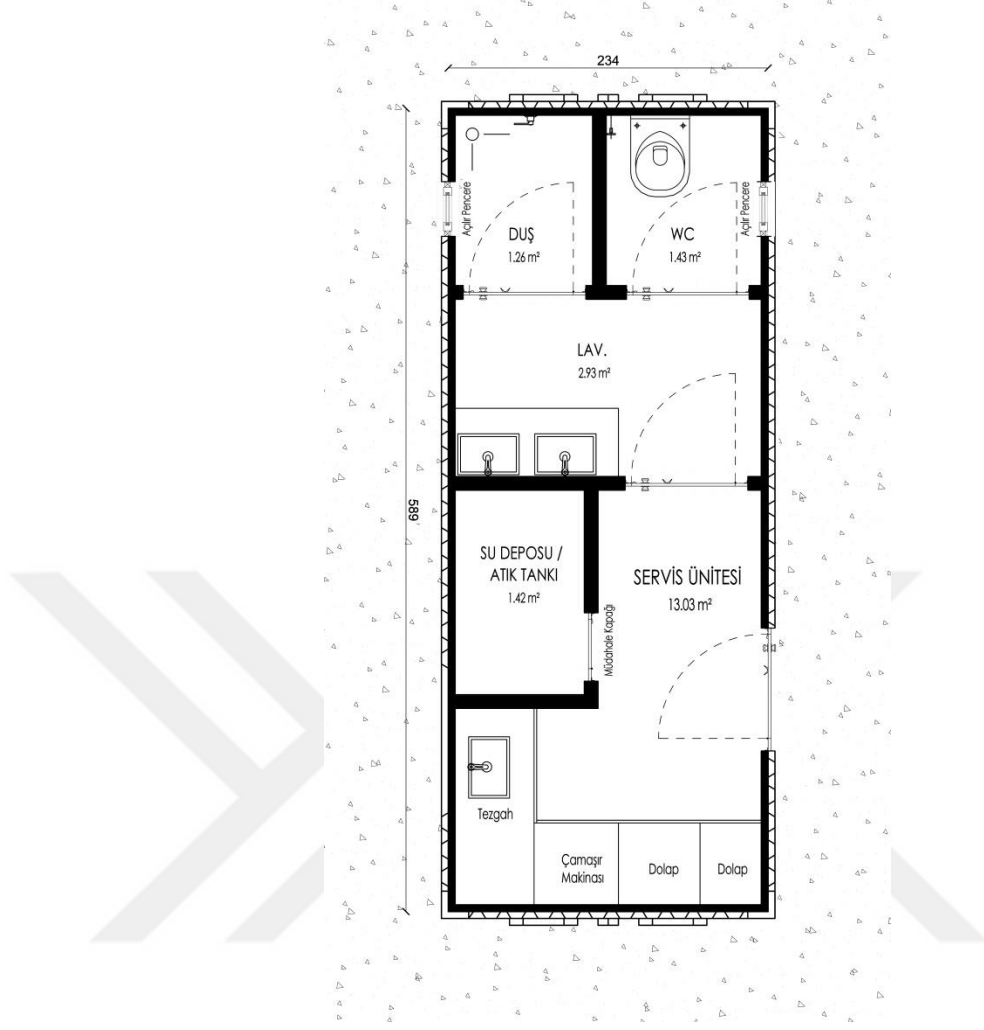
Şekil 27. 20' DC konteyner servis ünitesi plan şeması (Ö:1/500)
