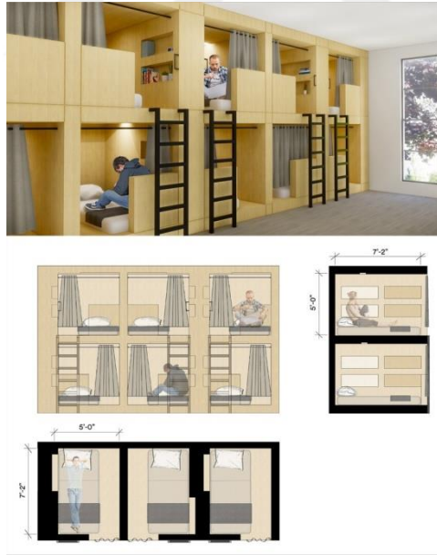
Şekil 21. Re-habit yatakhane plan, kesit ve görünüşleri
