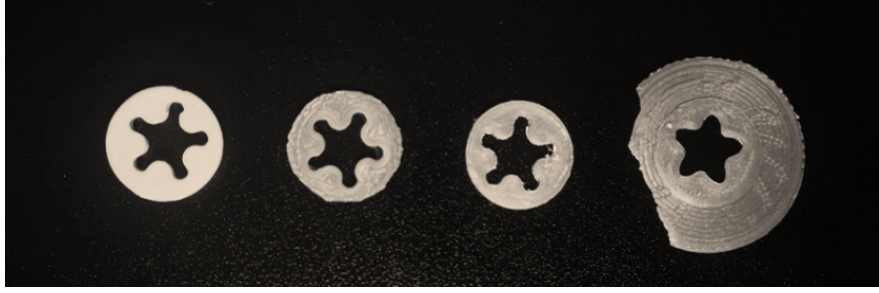
Şekil 4.3 : Tasarlanan ve 3B yazıcı ile üretilen kalıp denemeleri.
