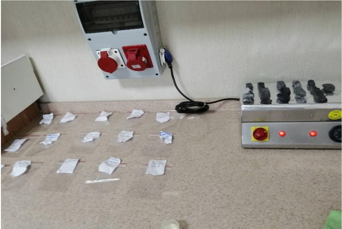
Resim 4.6 Hazırlanan ince kesitlerin ısıtıcı plakada kurutulması.
