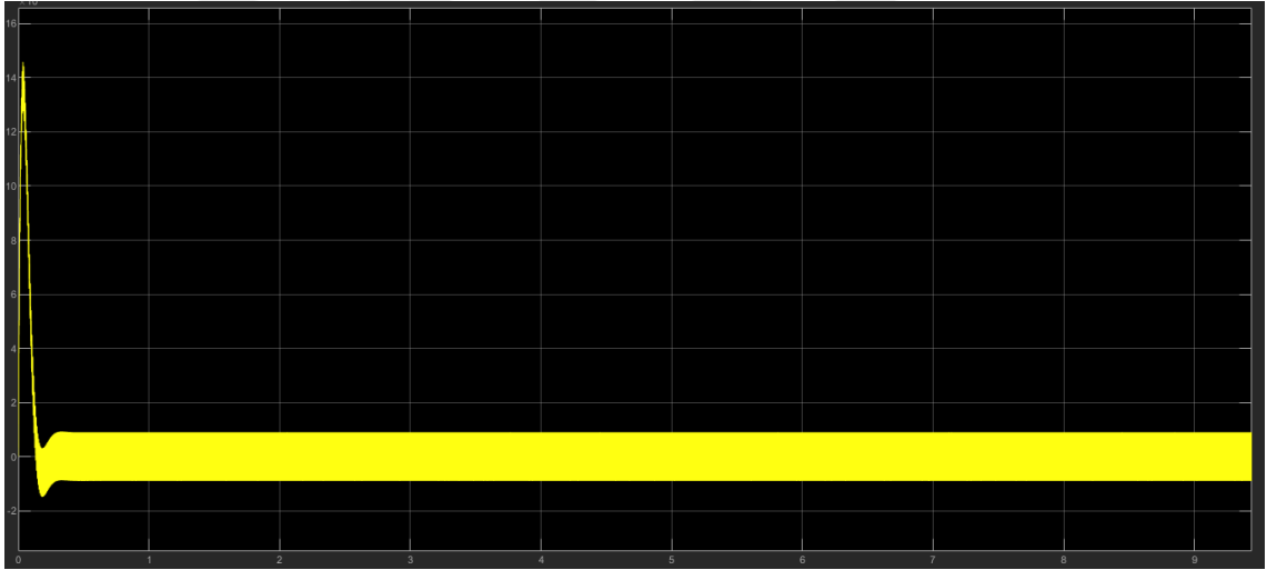
Şekil 3.7. Memristörlü alçak geçiren filtre devresinin 1kHz giriş sinyali için tepkisi.
