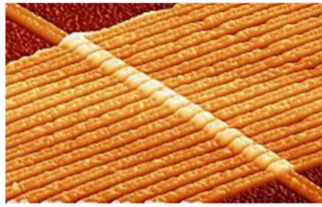
Şekil.1.3. Stanley Williams ve ekibinin ortaya koyduğu memristör yapısı (Williams ve ark.; 2008).
