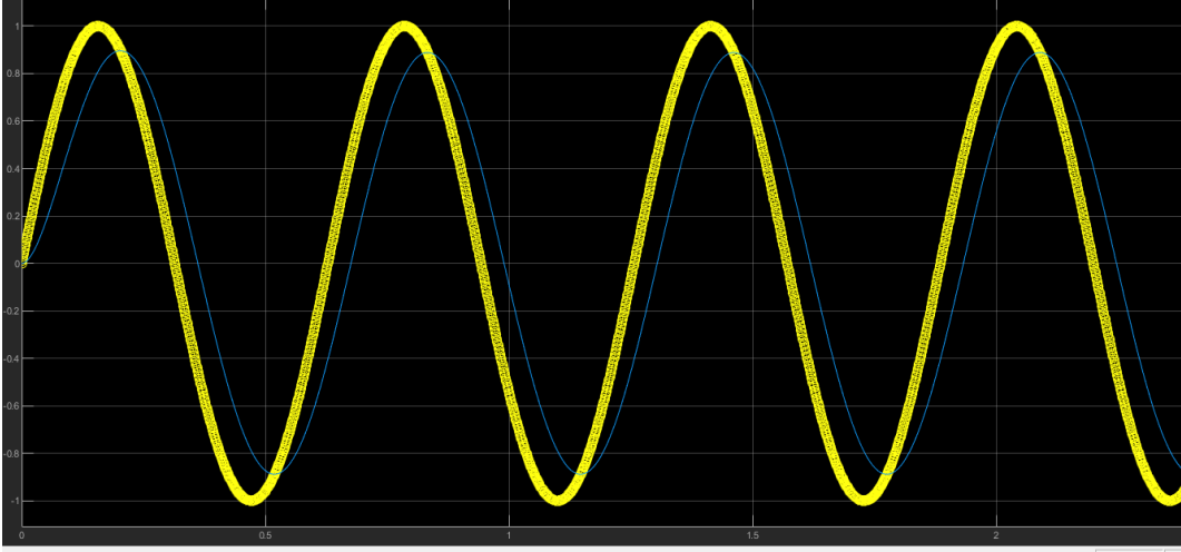
Şekil 4.3. Değişken dereceli yüksek geçiren filtre devresinin yüksek frekans sinyal tepkisi.
