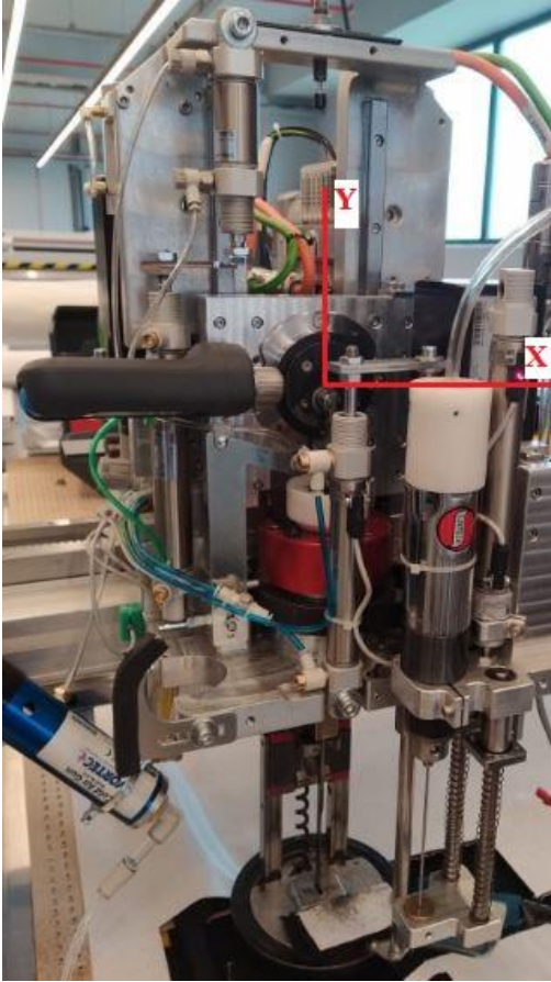
Şekil 2.22. Deney düzeneği ve titreşim ölçümü
