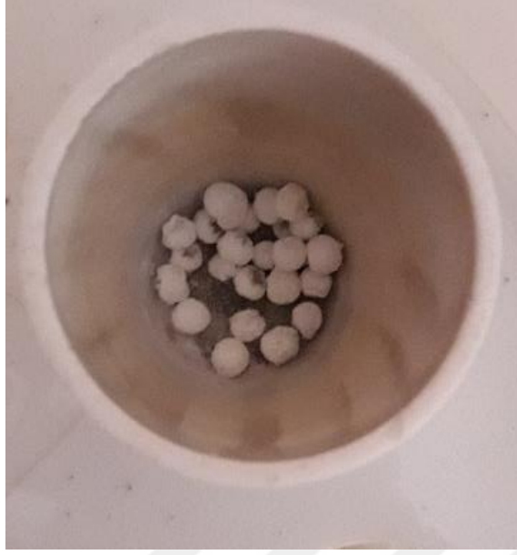
Şekil 5.4. Ateş dikenini meyvelerinin kül tayini sonrası kroze içerisindeki görünüşü
