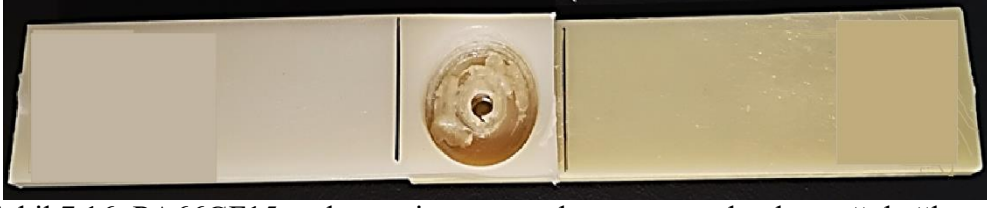
Şekil 7.16: PA66GF15 malzemesi sürtünme karıştırma nokta kaynağı bağlantısı
