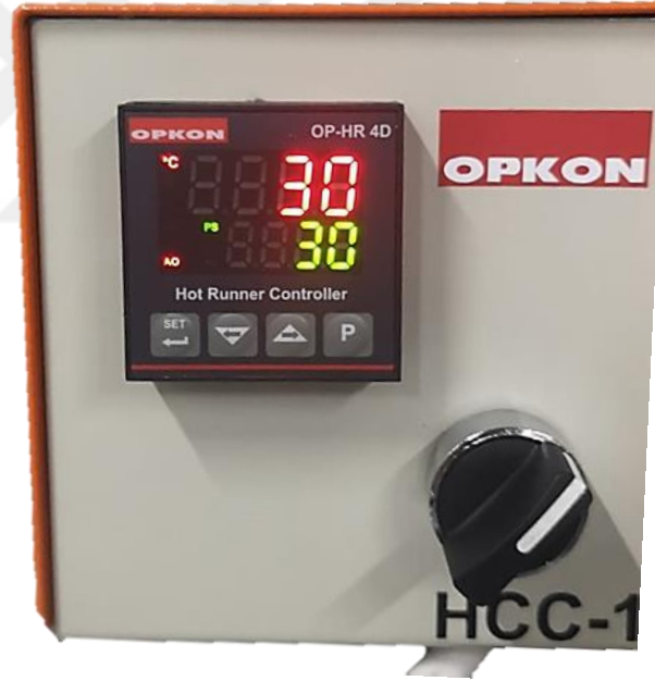
Şekil 7.12: Isı kontrol modülü
