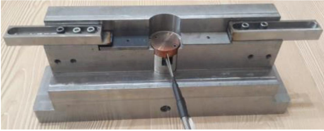
Şekil 7.3: Alttan ısıtmalı sürtünme karıştırma nokta kaynağı aparatı
