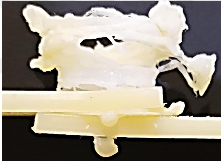
Şekil 6.5: Malzeme girişinin gerçekleştiği numune
