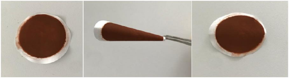
Şekil 14. 50 kez bükülme testinden önce ve sonra kırmızı çamur kaplı membranın fotoğrafları.
