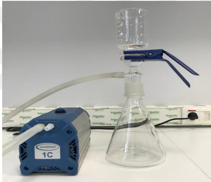
Şekil 12. Yağ-su emülsiyonlarını ayırmada kullanılan vakum filtrasyon sistemi
