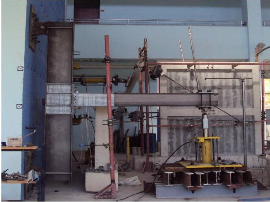
Şekil 4.2. Örnek birleşim sisteminin deney düzeneği (Hatipoğlu, 2011).
