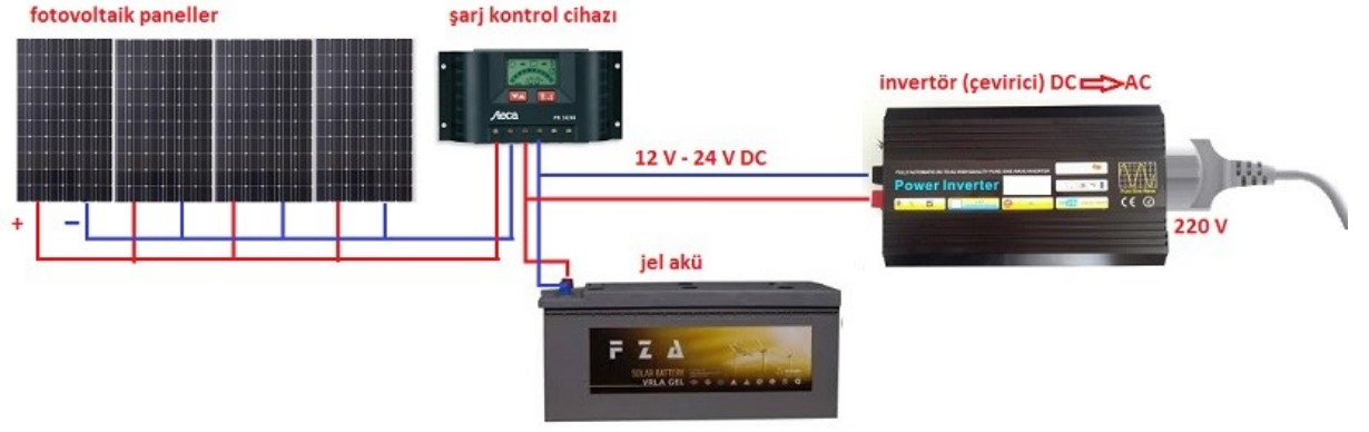
Şekil 12: Şebekeden bağımsız PV sistem örneği [14]
