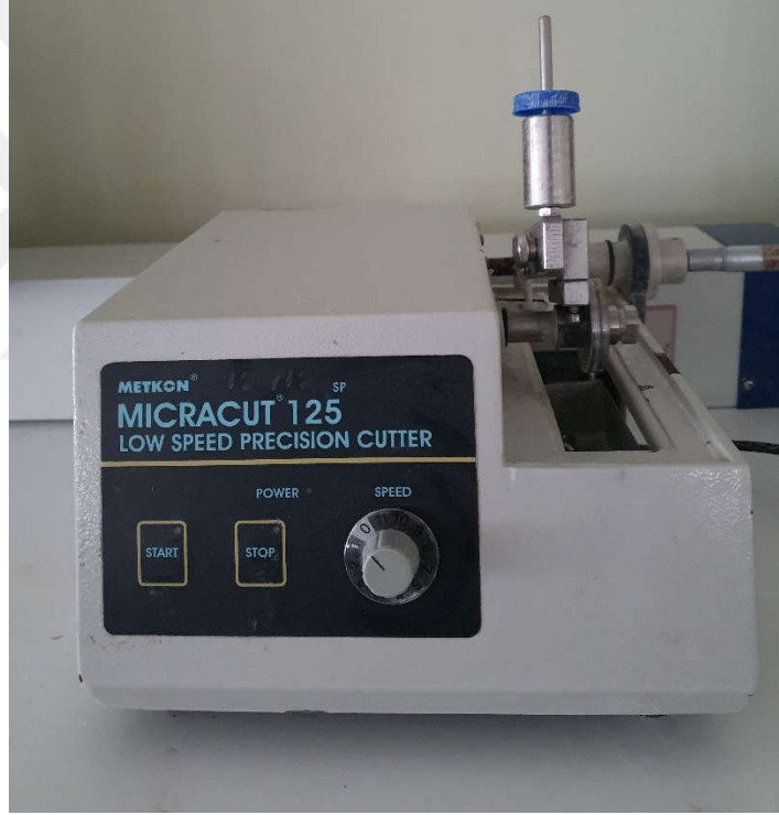
Resim 1: Çalışmada kullanılan Micracut 125 kesme makinesi
