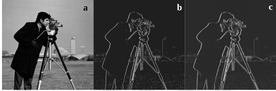
Şekil 4.9 a) Kameraman orijinal görüntüsü, b) Keyfi eşikleme ile Sobel kenar algılama, c) Kenar algılama yöntemi birleşik YSA
