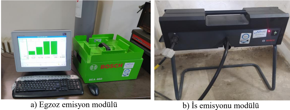
Şekil 4.9 Egzoz emisyon ölçüm cihazı
