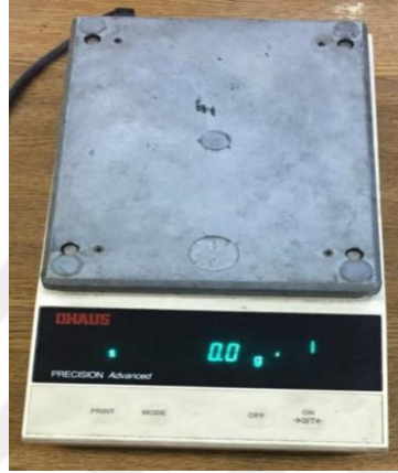
Şekil 4.6 Dizel ve dizel-biyodizel yakıt tüketimi ölçümünde kullanılan hassas terazi
