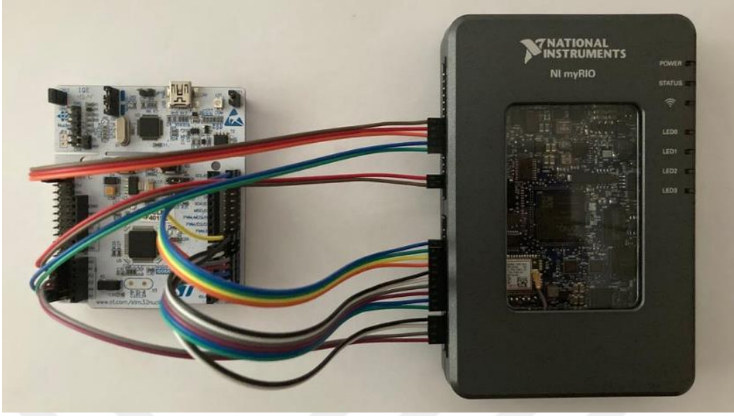
Şekil 2.39. Döngüde Donanım Test Sisteminin Görseli
