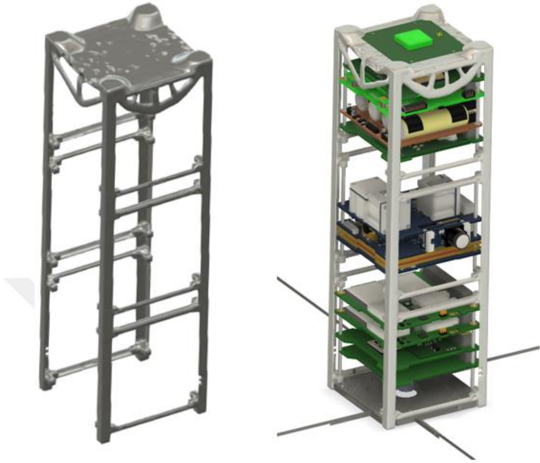
Şekil 6.6: Seçilen Üretken Tasarım Modelinin Alt Sistemler İle Birleştirilmesi.
