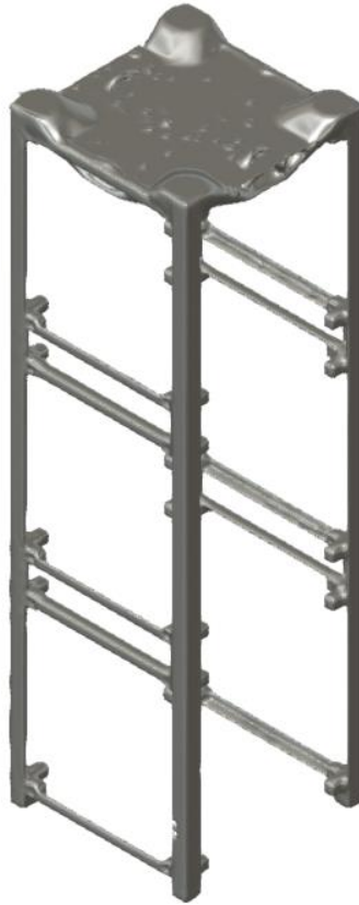
Şekil 6.4: Seçilen Üretken Tasarım Modeli.
