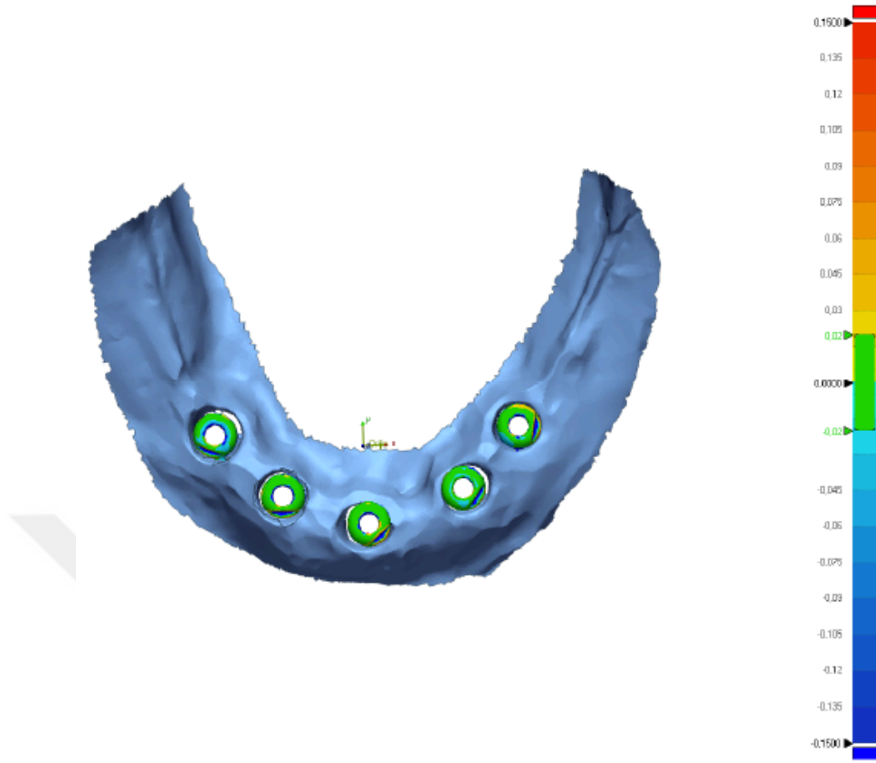
Resim 89: Medit i500 cihazı ile alınan dördüncü ölçünün renk haritası
