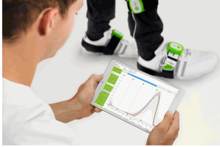
Şekil 2.8. Yürüyüşün incelenmesinde kullanılan ve kablosuz veri aktarımı sağlayan bir kayıt cihazı örneği (Hasomed, 2021).
