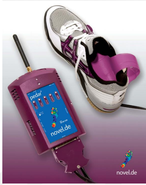
Şekil 2.11. Ayakkabı tabanlığına yerleştirilen 50 Hz frekanslı, 99 farklı sensör bulunan tabanlık-Pedar marka (Novel, 2021).
