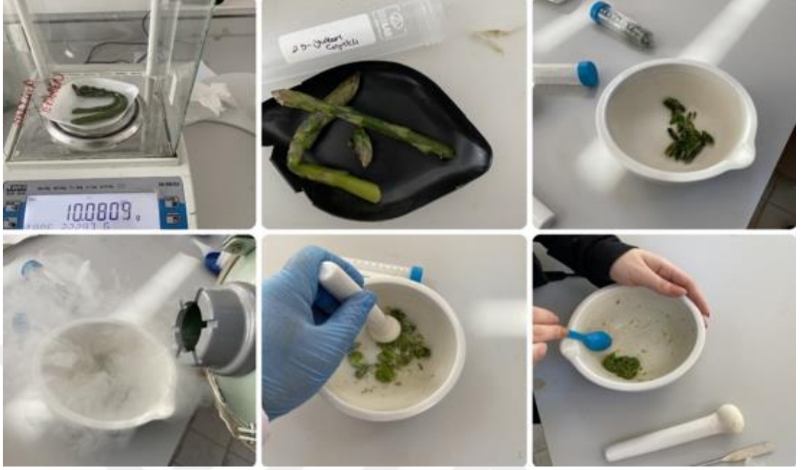
Şekil 3.4. Kuşkonmaz sürgünlerinin tartımı ve sıvı azot altında parçalanması
