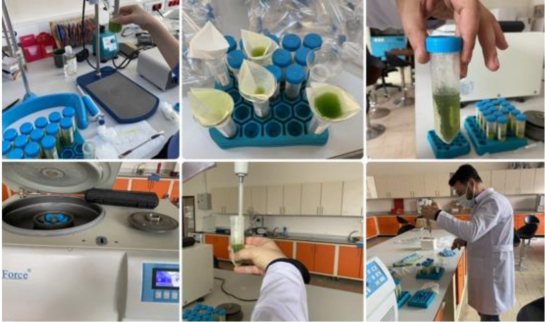
Şekil 3.6. Kuşkonmaz sürgünlerinin parçalama sonrası ince filtrelerde süzülmesi ve santrifüjlenmesi
