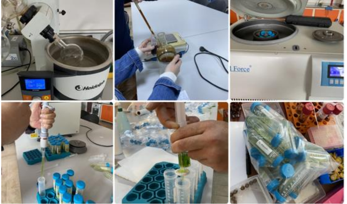
Şekil 3.7. Santrifüj sonrası örneklerin evaporatörden geçirilmesi, tekrar santrifüjlenmesi ve SPE filtrelerden geçirilmesi
