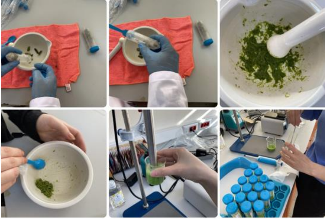
Şekil 3.5. Kuşkonmaz sürgünlerinin havanla dövülmesi homojenizatörde parçalanması
