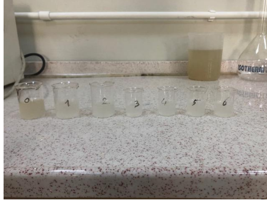
Şekil 4.13. O 3 /H 2 O 2 prosesinin numune bulanıklığına etkisi
