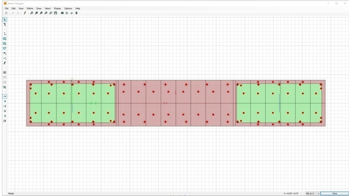
Şekil 4.10. 40x260 cm Perde Kesit (lif) Hücreleri Tanıtımı
