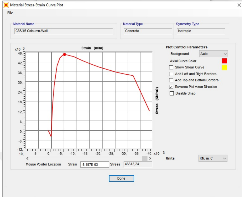
Şekil 4.2. Perde ve Kolon Elemanlar İçin Kullanılan C35 Sargılı Beton Modeli
