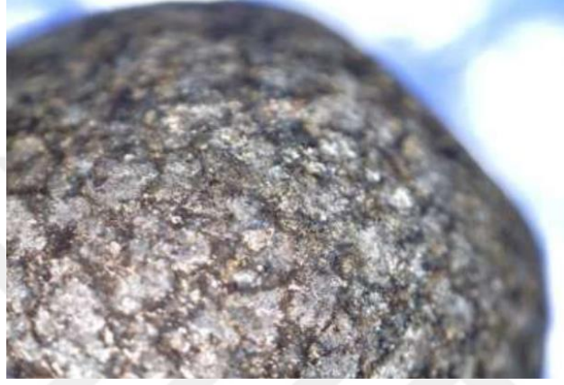
Şekil 3.7 : ESD Yöntemi ile punta nokta kaynağının bakır keplerinin seramik fazlarla kaplanması [51].
