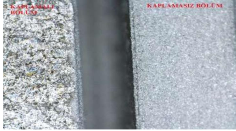
Şekil 3.8 : ESD Yöntemi ile pistonun yüzeyi Ni kaplaması [52].
