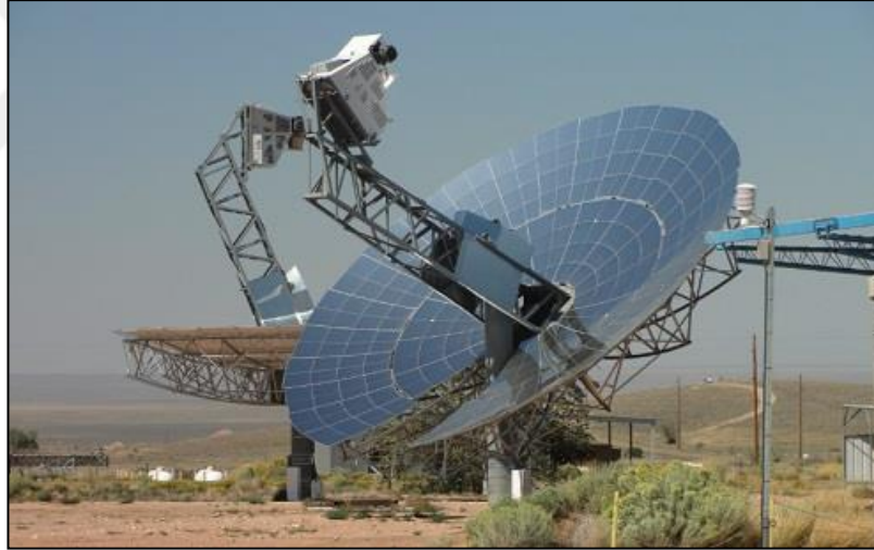
Şekil 4.2 Noktasal yoğunlaştırıcılar ile elektrik üretimi
