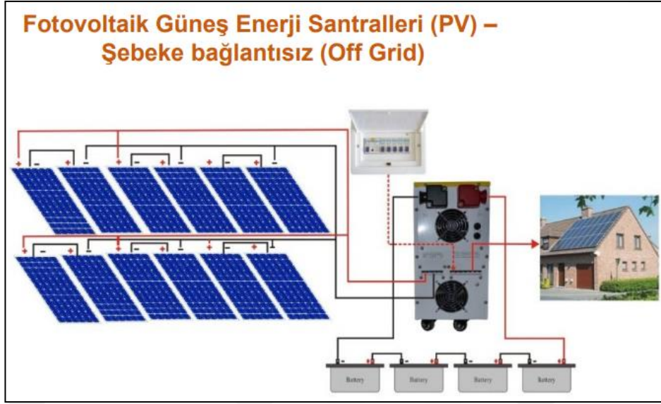
Şekil 4.7 Şebekeye bağlantısız fotovoltaik güneş enerji santrali
