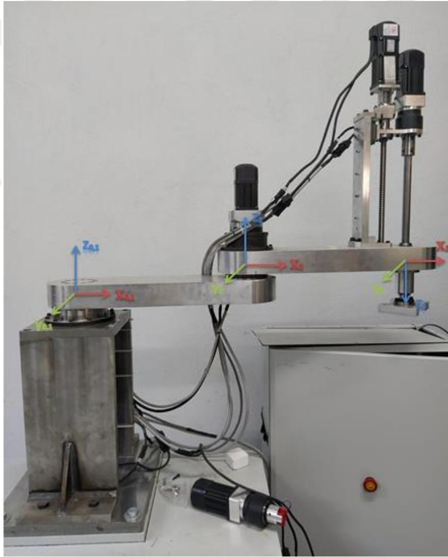
Şekil 3.2: Koordinat Sistemlerin Robotun Üzerine Yerleştirilmesi
