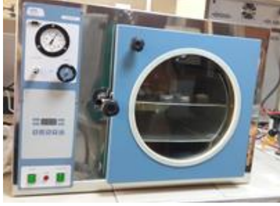
Şekil 3.7: Deneylerde kullanılan vakum etüvü.
