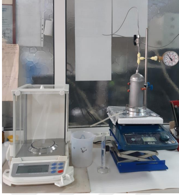
Şekil 3.11: Laboratuvar ölçekli ters osmoz sisteminin görüntüsü.
