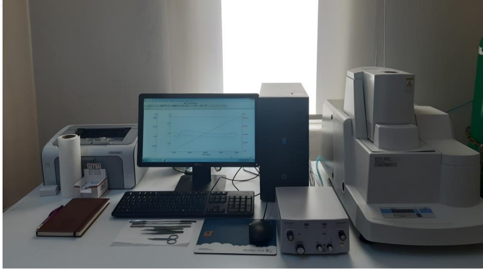
Şekil 3.9: Termogravimetrik analiz cihazı.
