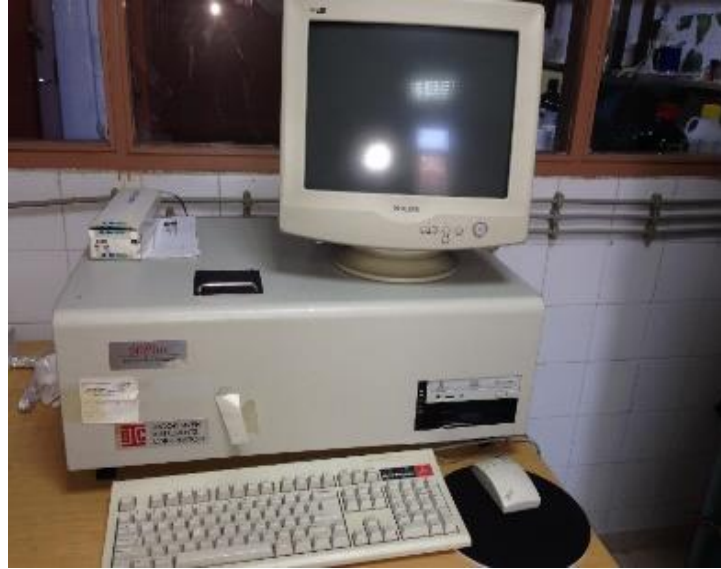
Şekil 3.8: Partikül boyutu analiz cihazı.
