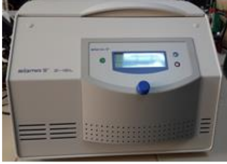
Şekil 3.2: Deneylerde kullanılan santrifüj cihazı.
