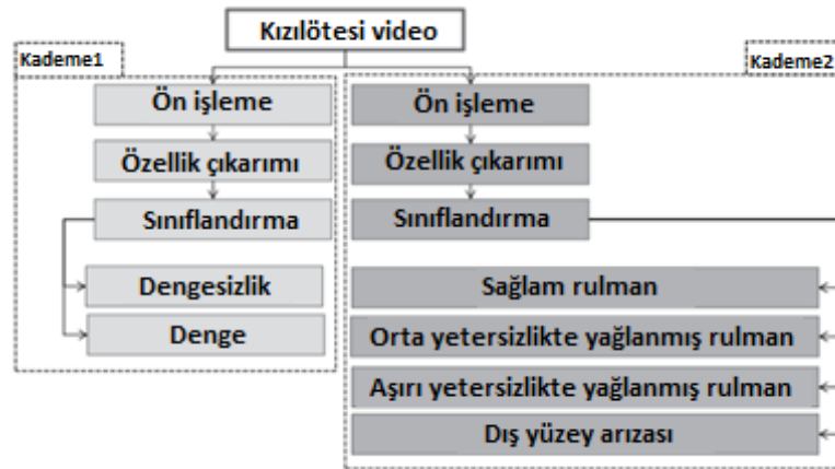
Şekil 2.6. İki kademeli ısı görüntü işleme blok diyagramı [6]
