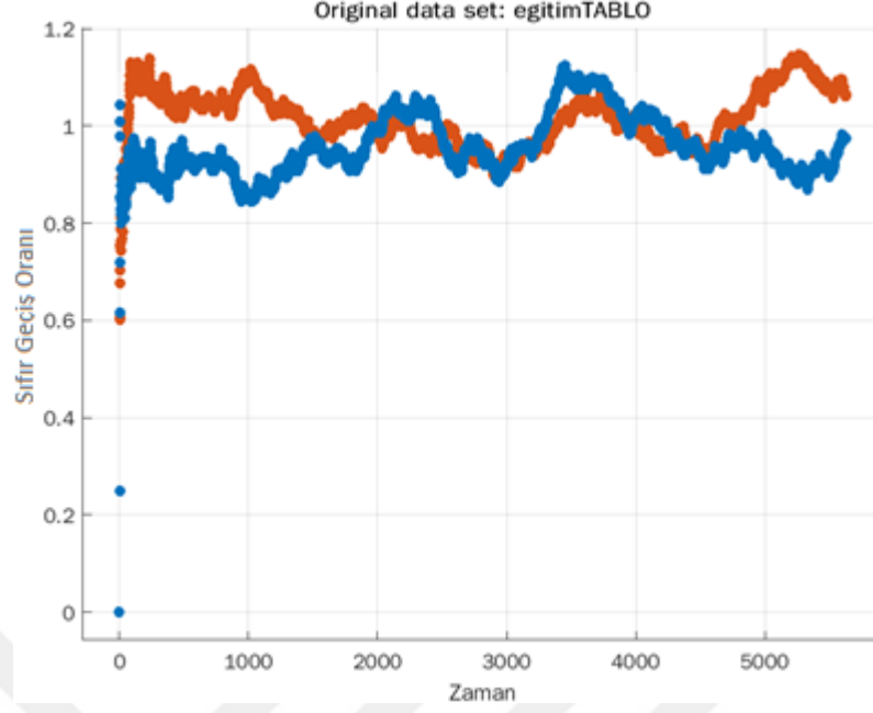
Şekil 4.7. Arızalı (mavi) ve sağlam (turuncu) motora ait ses sinyallerinin sıfır geçiş oranlarının zaman içinde değişimi
