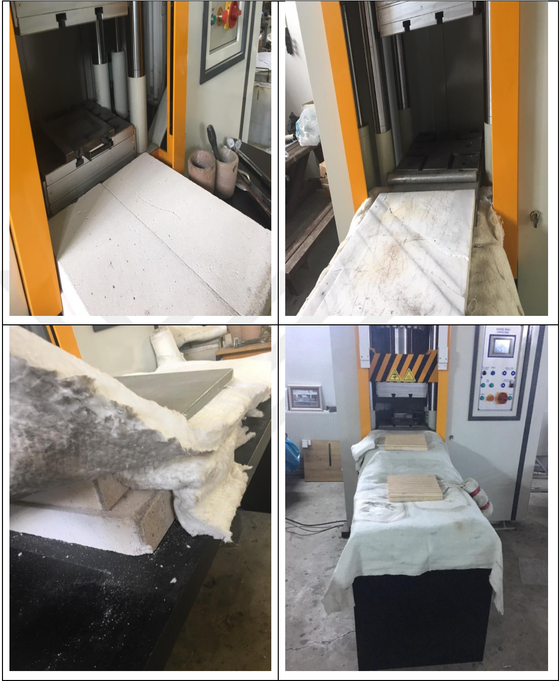
Şekil 2. 1. Pres önünde ısıtma tertibatı için hazırlanan tezgâh ve yapısı (ytong tuğlalar, cam yünü, mermer blok, rezistanslar).
