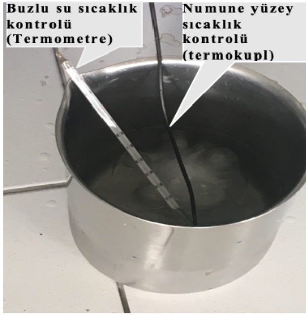
Şekil 3. 19. Buzlu su ile soğutma tertibatı.
