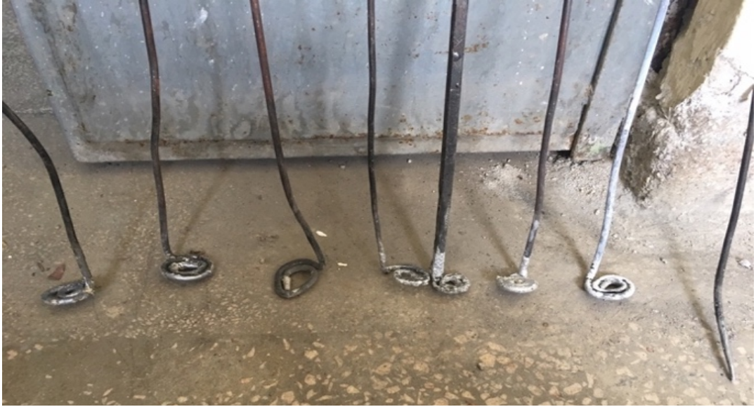
Şekil 2. 9. Yarı-katı metal karıştırma işlemlerinde kullanılan karıştırıcılar.
