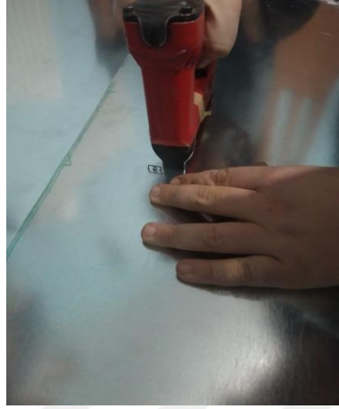
Resim 4.2 Darrieus kanat iskeletinin sac malzemeye zımbalanması.
