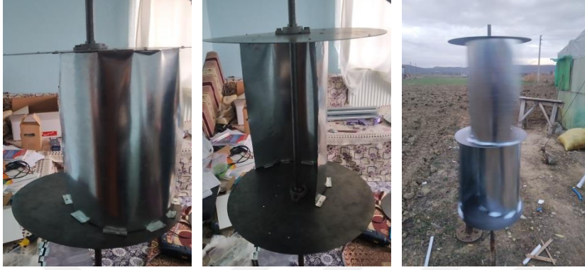
Resim 4.3 Savonius kanatlarının yapımı, mile sabitlenmesi ve son halinin dönme denemesi.
