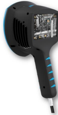
Şekil 4.8 Ultrasonik akustik kamera [15]
