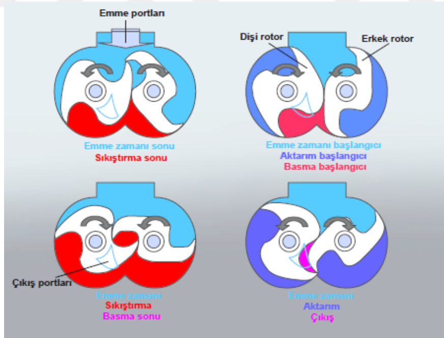
Şekil 3.8 Çift dişli kompresörün çalışma prensibi [11]
