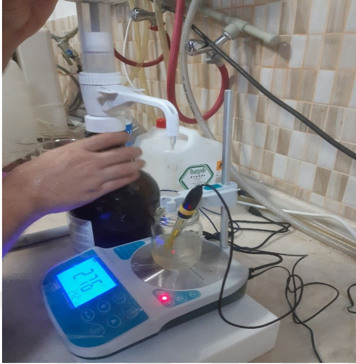
Şekil 3.18. pH metrenin görünümü
