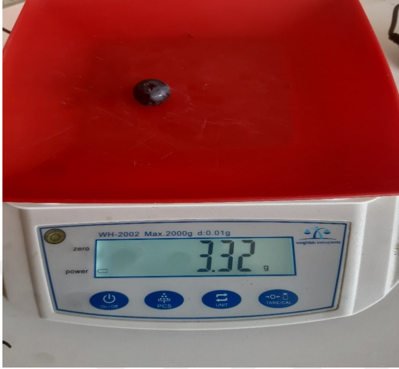
Şekil 3.14. Tane ağırlığının ölçülmesinde kullanılan 0,001gr hassasiyetli dijital terazi
