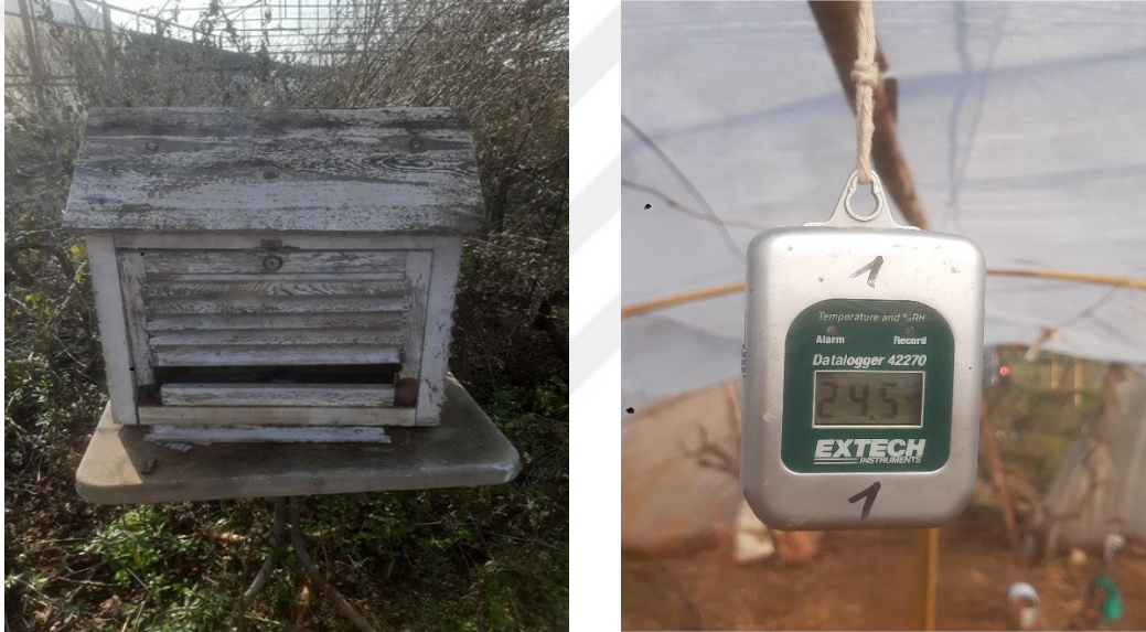
Şekil 3.5. Meteoroloji siperi ve dataloger
