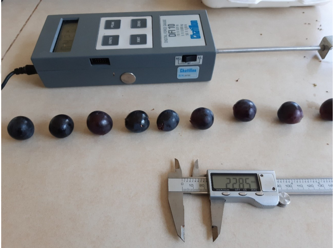
Şekil 3.13. Tanede en ve boy ölçülmesinde kullanılan dijital kumpas
