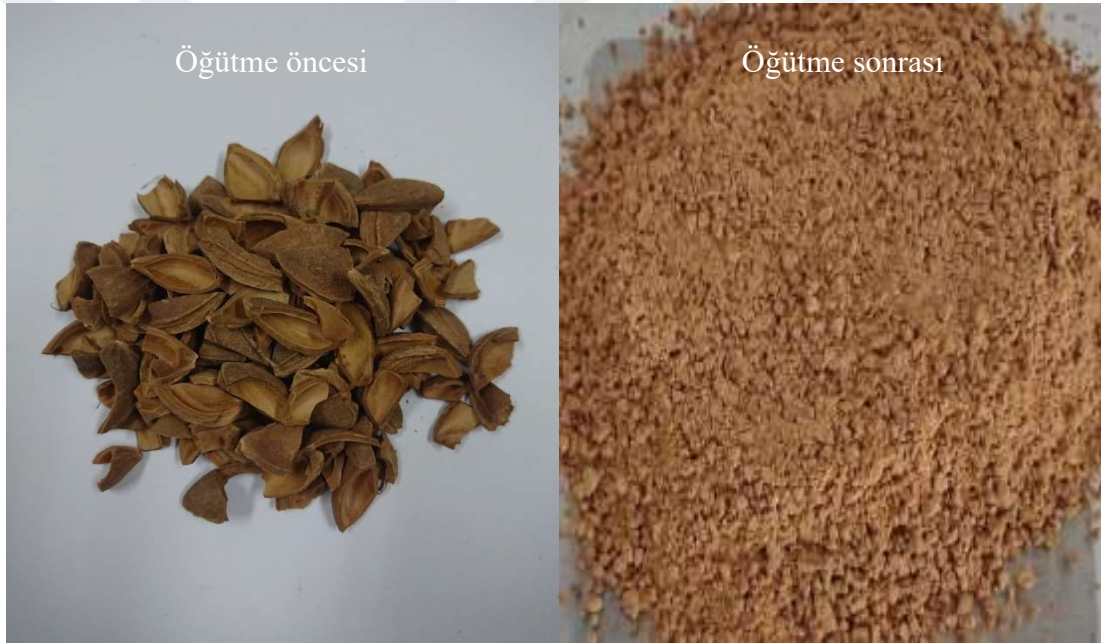
Şekil 4.4. Kayısı Çekirdeği Kabuklarının Öğütme İşleminde Önceki ve Sonraki Boyutları
