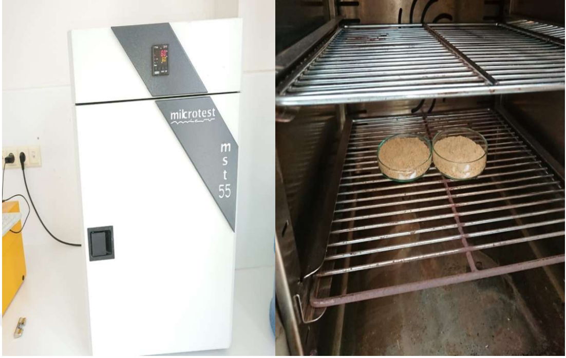
Şekil 4.5. Kurutmada Kullanılan Fırın ve Kurutma Şekli
