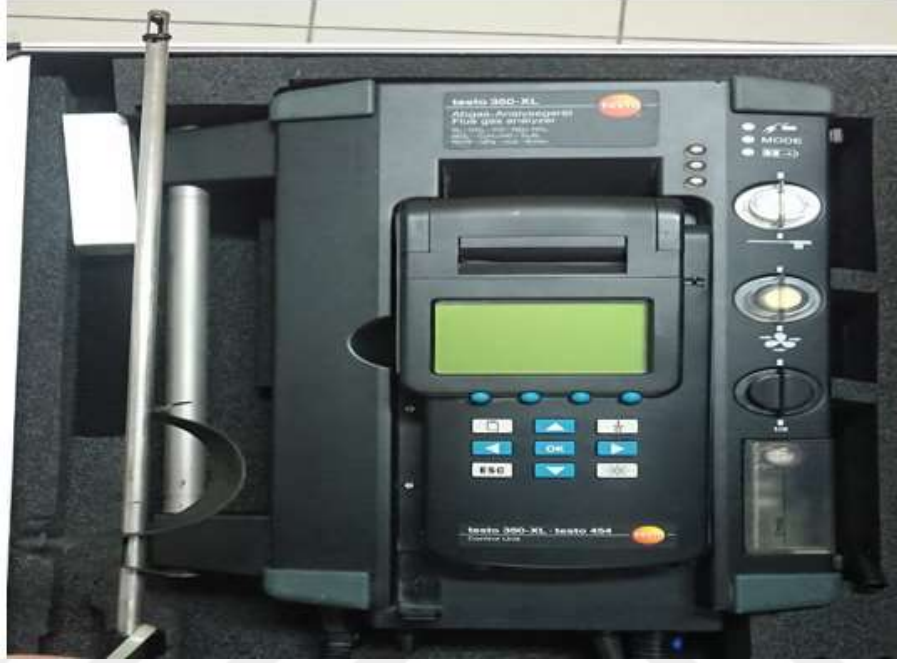
Şekil 4.8. TESTO-350 XL Emisyon Ölçüm Cihazı
