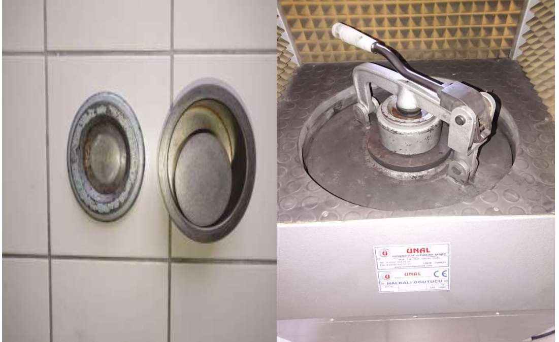
Şekil 4.3. Biyokütleri öğütmede kullanılan halkalı öğütücü
