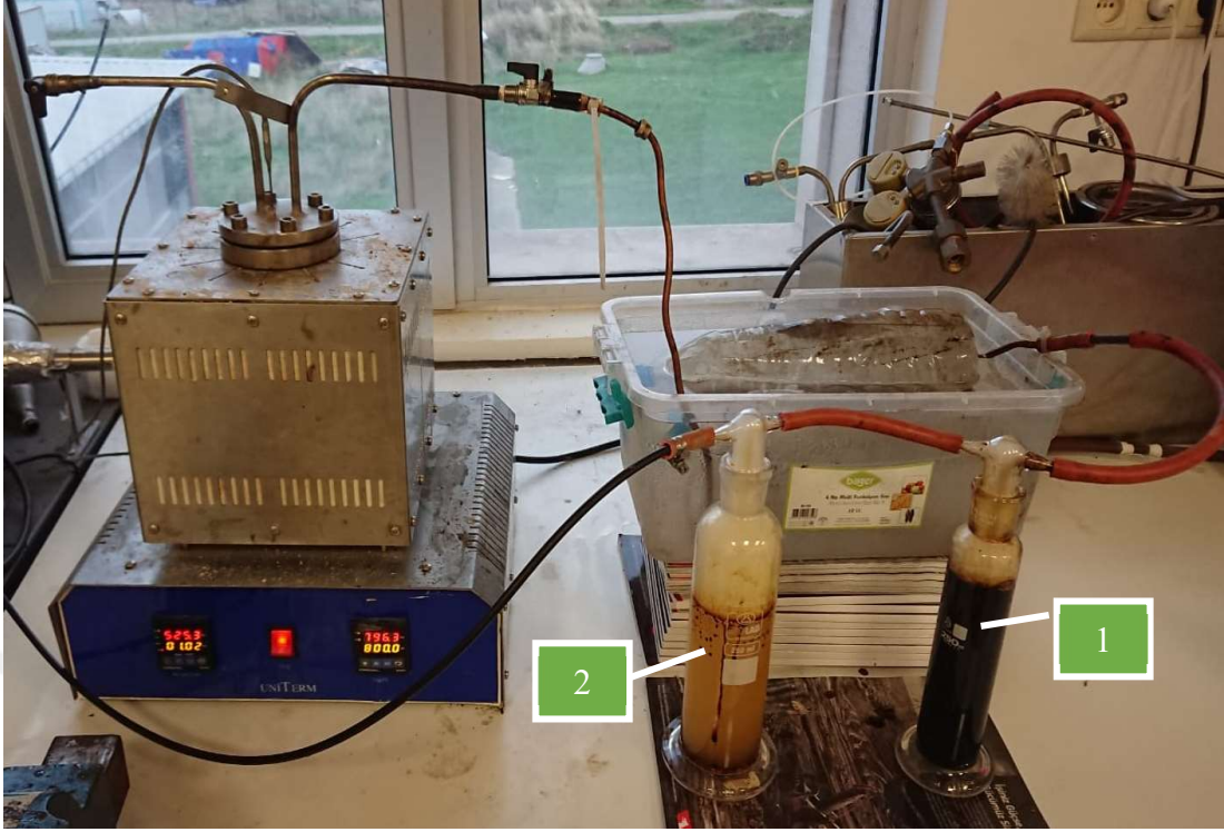
Şekil 4.6. Pirolitik Biyoyeğ Üretimi İçin Kurulan Piroliz Deney Düzenegi
